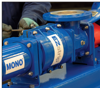
Skru boltene af, og del pumpehuset i to
