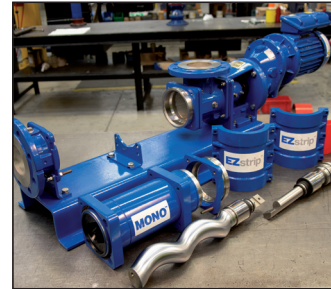
Nu kan sliddelene udskiftes, og pumpen kan samles hurtigt igen.
