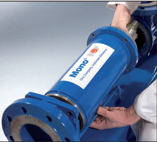
Løft rotor og stator ud af pumpen
