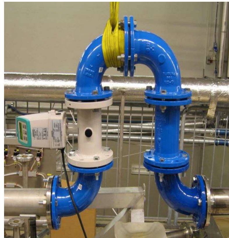
Test 7 – Måler + 4 x 90° rørbend, måler orientert 0°
