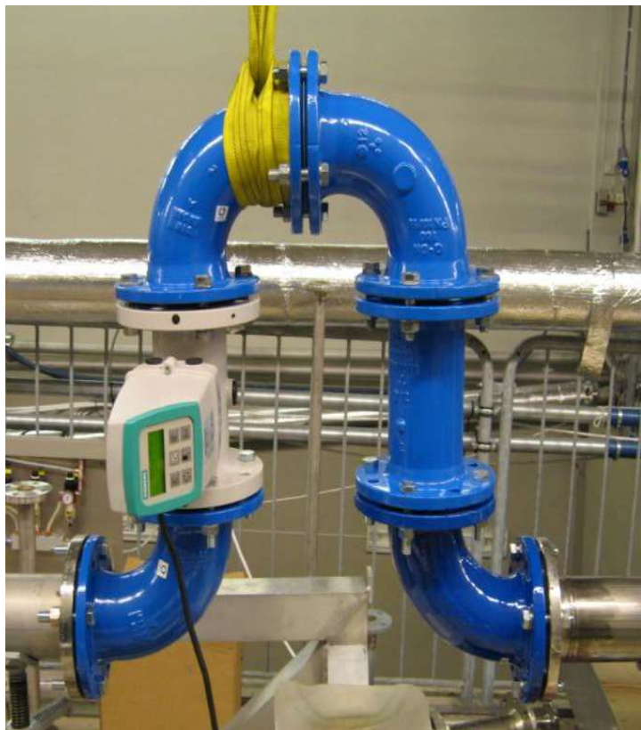
Test 6 – Måler + 4 x 90° rørbend, måler orientert 90°
