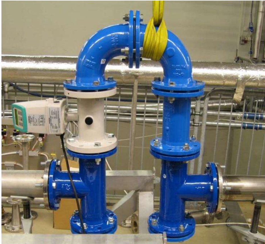
Test 4 – Måler + 2 x 90° rørbend + 2 x T-rør, Måler orientert 0°
