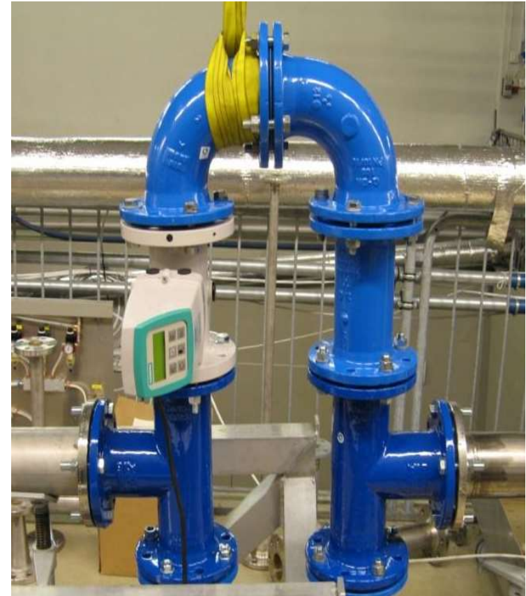
Test 5 – Måler + 2 x 90° rørbend + 2 x T-rør, Måler orientert 90°
