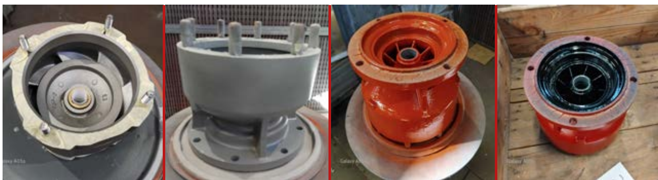
Trattamento ceramico delle parti interne di una pompa
