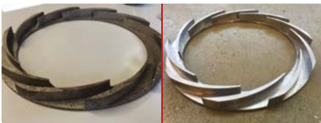
Trattamento ceramico delle parti interne di una pompa
