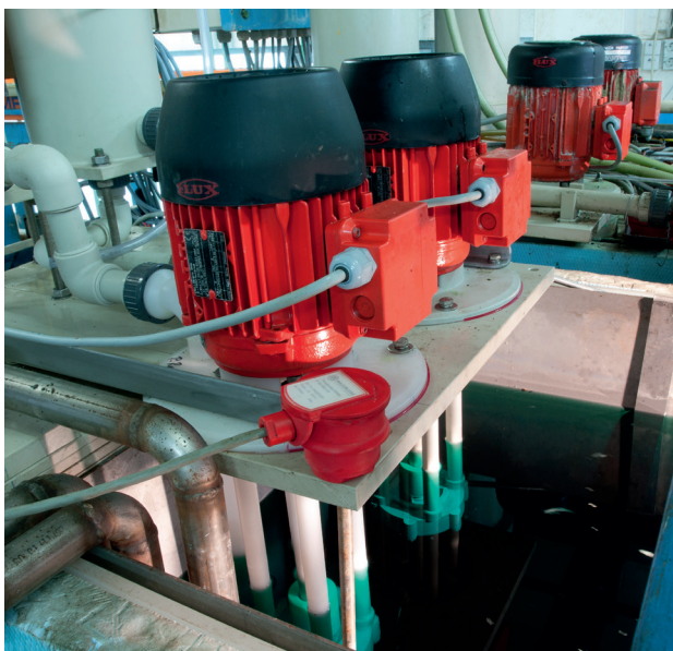
F 716 – Circolazione di sostanze chimiche in una vasca di galvanizzazione.
