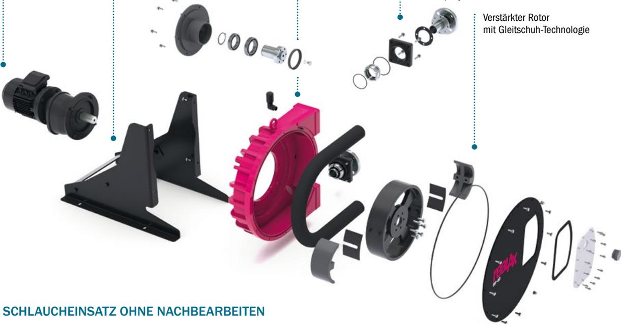
Die integrierte Rotor-Lagerung reduziert die Getriebebelastung, gerade auch bei hoher Leistung im Dauerbetrieb. Durch Clamp-Anschlüsse wird der Schlauchwechsel besonders einfach gestaltet.
