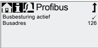
Afb. 36 Voorbeeld van submenu voor Profibus®
