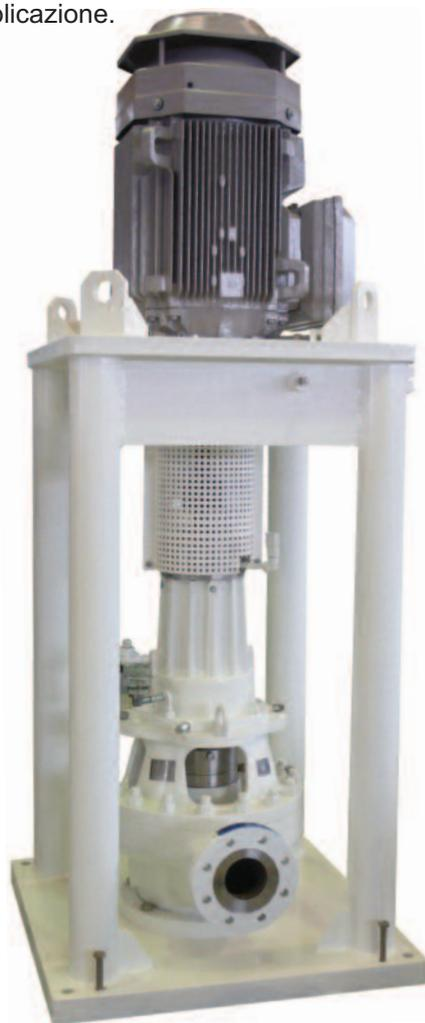
Le pompe della serie PEP, realizzate in accordo alle norme API 610, sono state specificatamente progettate per applicazioni con basse portate, prevalenze medio-alte, con bassi valori di NPSHa, senza ricorrere all'ausilio di moltiplicatore di giri.
