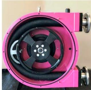
11. Den zweiten Gleitschuh mit Shimbleche wieder am Rotor befestigen.
