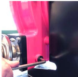
13. Die Frontabdeckung am Pumpengehäuse befestigen.
