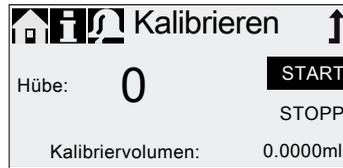
5. Die Pumpe führt 200 Dosierhübe aus und zeigt dann den werkseitigen Kalibrierwert (z. B. 125 ml) an.
