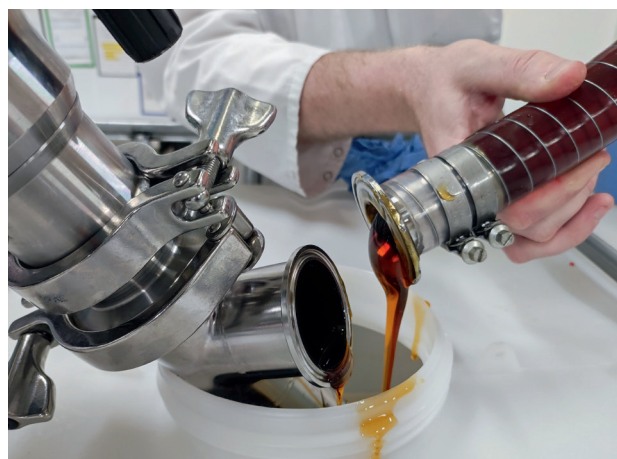
Trasporto di sciroppo viscoso di canna da zucchero in uno stabilimento di produzione di biscotticon la pompa a vite eccentrica VISCOPOWER F 580.
