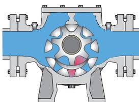
Il liquido viene trasferito nella zona di scarico. Le pareti del corpo pompa ed il setto divisorio creano una tenuta tra il lato d'aspirazione ed il lato di scarico della pompa.
