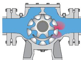
Quando i denti si avvicinano, si crea una sovrappressione che spinge il liquido nella zona di scarico.
