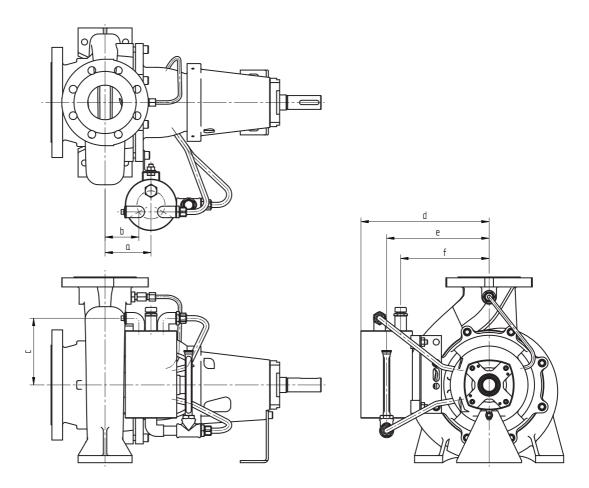
Figure 39: Shaft sealing configuration MQ2-MQ3-CQ3
