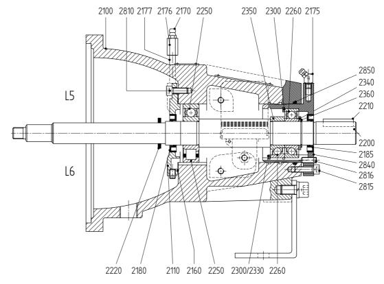
Figure 33: Bearing L5-L6 of 25-125, 25-160).
