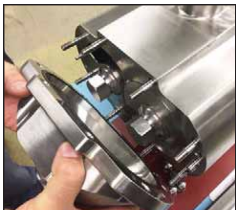
Bild 128 – Montering av pumphölje
