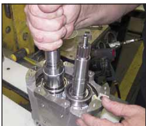
Bild 189 – Placera drivaxeln i dess hålet
