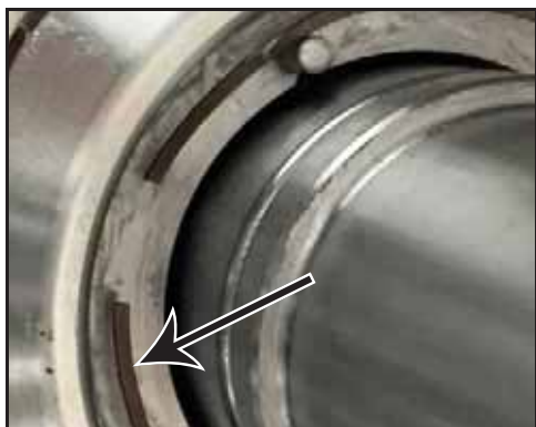
Bild 50 – Borttagning av vågfjädern
