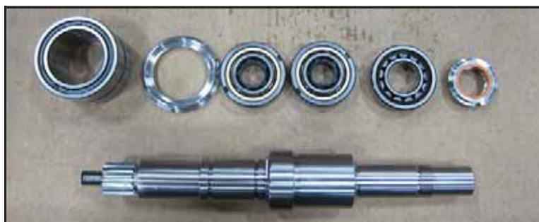
Bild 151 – Kort axel: Komponenter
