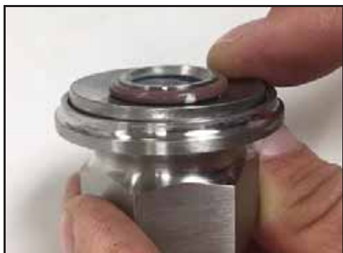
Bild 115 – Monterad konisk fjäderbricka
