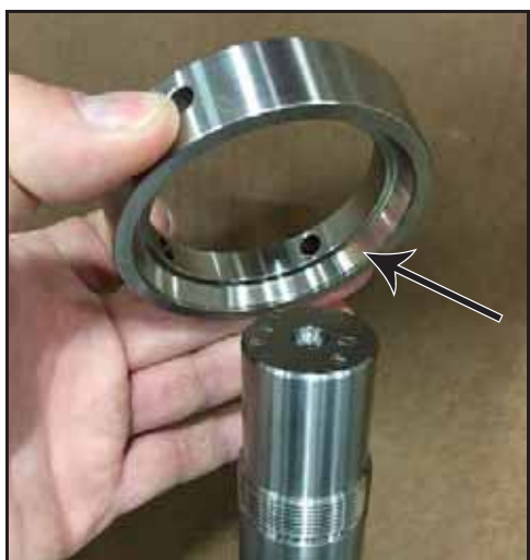
Bild 157 – Placera lagrets mellanlägg på axeln
