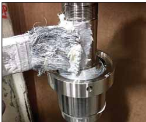
Bild 161 – Applicera antikärvmiddel på axeln
