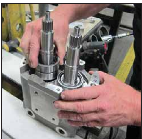
Bild 190 – Placera den yttre ringen på axeln
