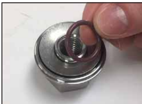
Bild 39 – Ta bort O-ringen som håller brickan på plats
