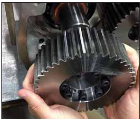
Bild 213 – Montera kugghjul på pumpaxlar
