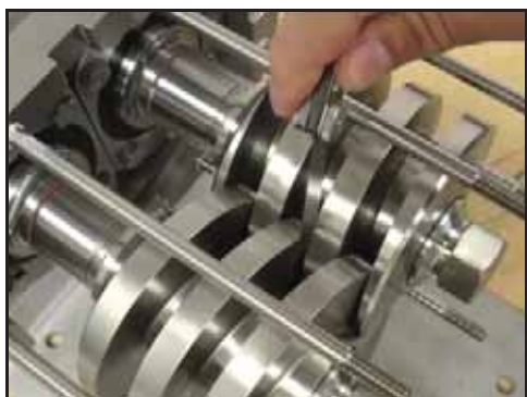
Bild 222 – Mätning av spel
