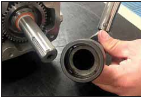
Bild 140 – Momentnyckel för drivaxel
