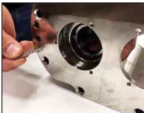
Bild 77 – Använd drivstift för att rikta in hål
