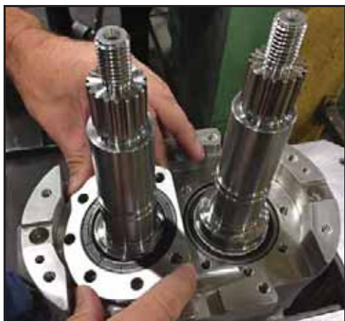
Bild 144 – Ta bort lagerhållare
