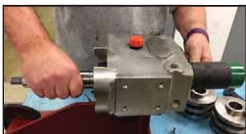
Bild 147 – Knacka loss den korta axeln ur växellådan
