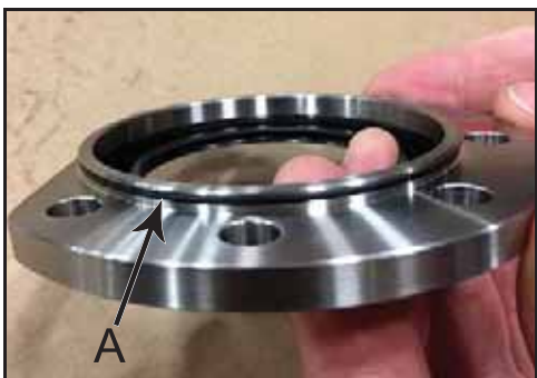
Bild 197 – lagerhållarens O-ring monterad
