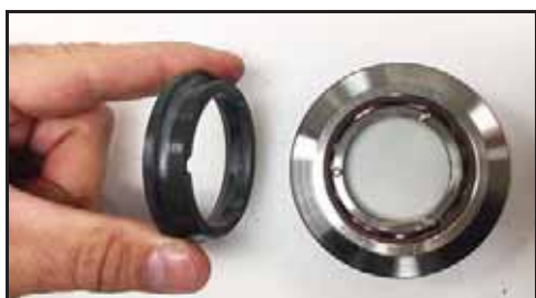
Bild 73 – Smörj och installera tätning
