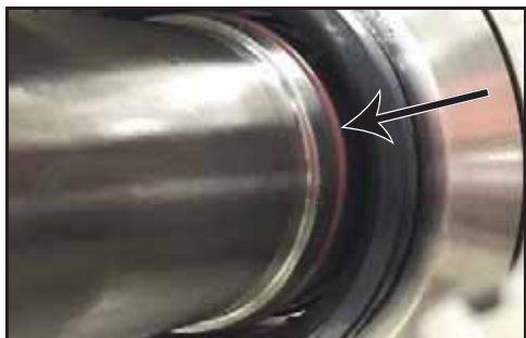
Bild 91 – Montering av axelns O-ring
