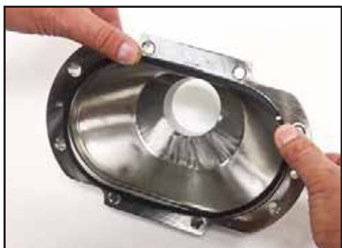
Bild 127 – Montera höljets packning
