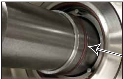
Bild 94 – Montering av axelns O-ring
