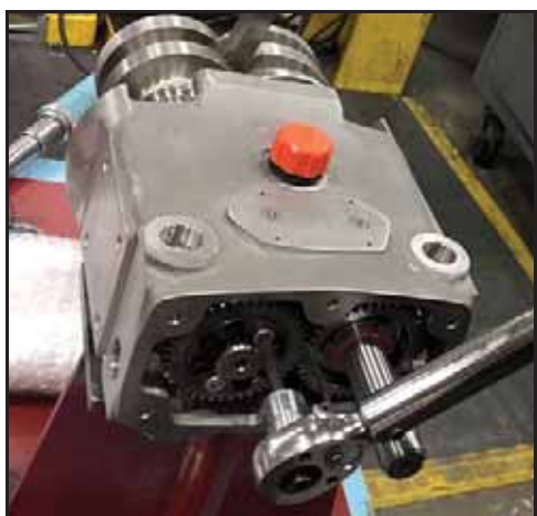
Bild 227 – Momentdragning av låsbultar
