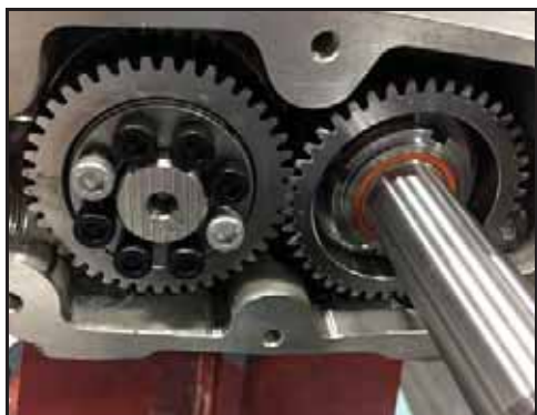
Bild 214 – Rikta in det fria kugghjulet med drivkugghjulet
