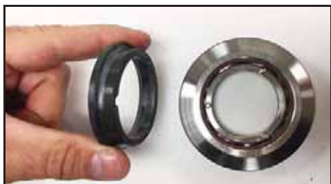
Bild 58 – Ta bort tätning
