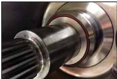
Bild 104 – Packbox monterad på axel
