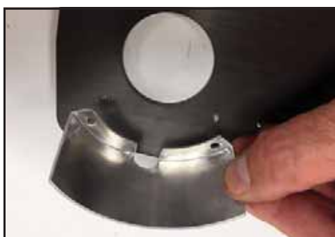
Bild 230 – Rikta in skruvhål
