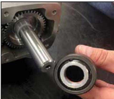
Bild 142 – Ta bort låsmutter och kugghjul
