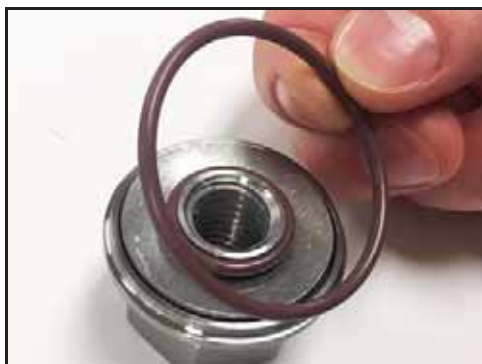
Bild 38 – Ta bort mutterns O-ring
