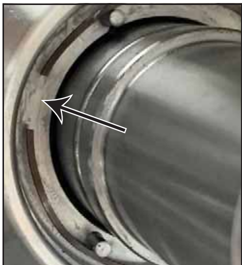
Bild 68 – Våg fjäderns position
