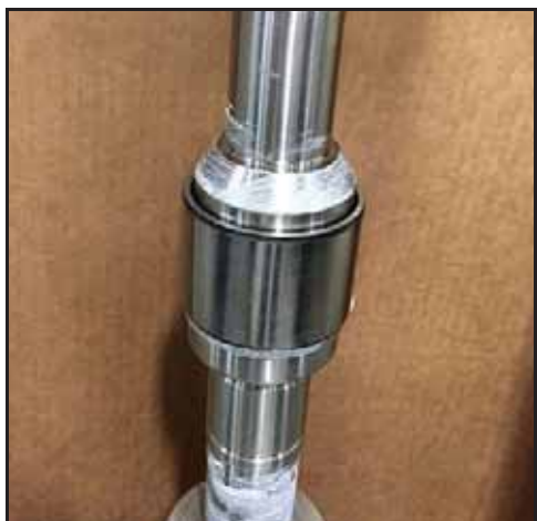
Bild 156 – Den inre ringen är installerad på axeln
