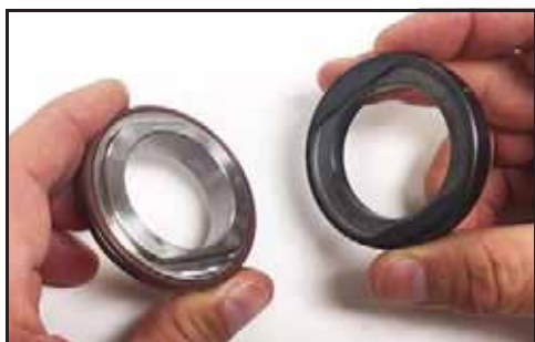
Bild 44 – Montera isär boxen och sätet
