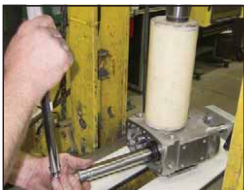
Bild 207 – Momentdragning av låsmuttern
