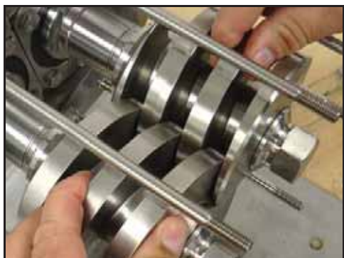
Bild 221 – Mätning av spel
