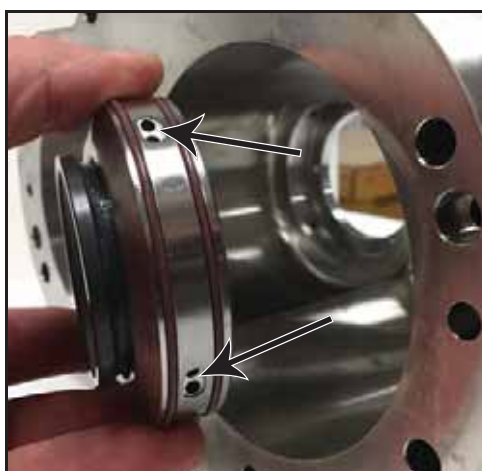
Bild 76 – Installera tätningshållare i pumphuset
