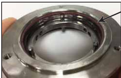
Bild 72 – Monterad O-ring mellan tätningshållare och tätning
