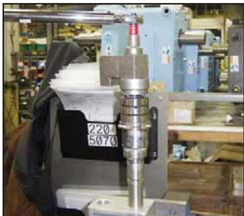
Bild 179 – Momentdragning av låsmuttern
