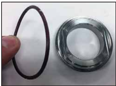
Bild 46 – Ta bort O-ring som sitter mellan boxen och sätet
