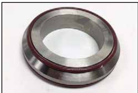
Bild 100 – Monterad O-ring mellan packbox och skruv
