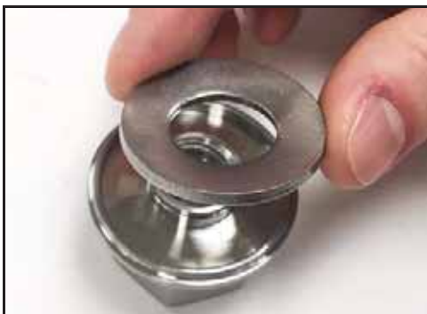
Bild 113 – Installera konisk fjäderbricka
