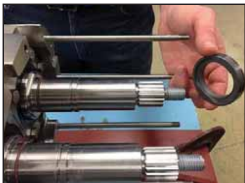
Bild 85 – Montering av tätningarnas säten
