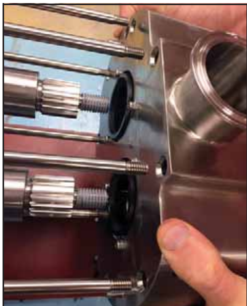
Bild 87 – Montering av pumphus på axlar
