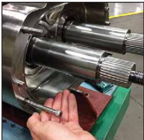
Bild 90 – Montering av pumphusets fästskruvar
