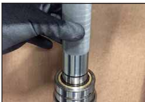
Bild 176 – Tryck fast ringen på axeln
