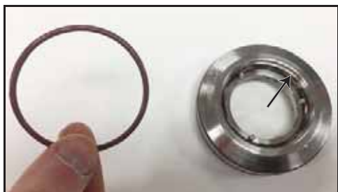
Bild 69 – O-ring mellan tätningshållare och tätning
