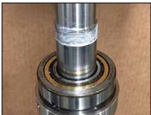
Bild 167 – Ringen installerad på axeln
