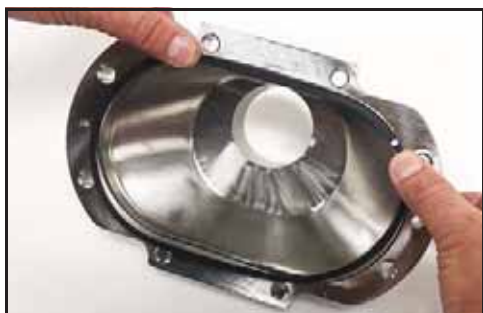
Bild 29 – Ta bort höljets packning
