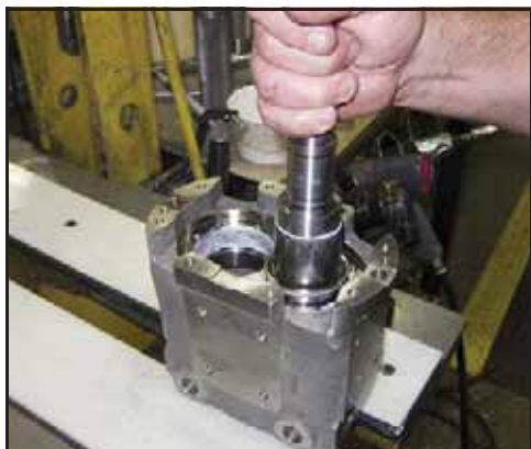
Bild 186 – Placera den korta axeln i hålet
