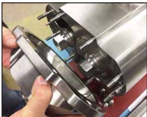
Bild 28 – Ta bort pumpens hölje
