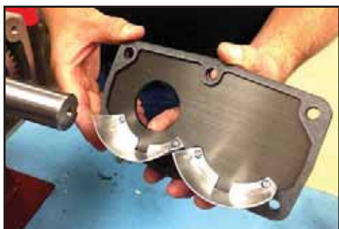
Bild 234 – Placera packningen på höljet
