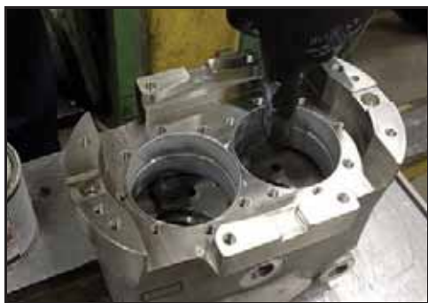
Bild 185 – Sprid ut ett jämnt lager
