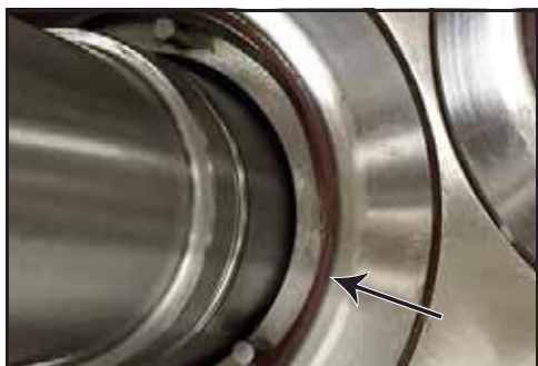
Bild 49 – Ta bort O-ring mellan tätningshållaren och tätningen
