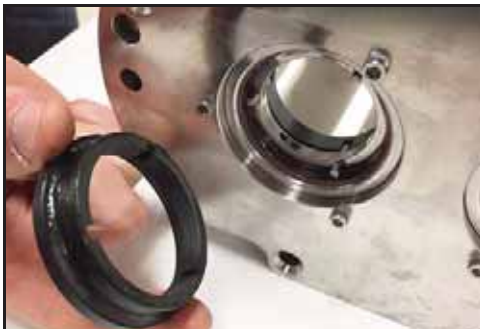
Bild 55 – Ta bort tätning
