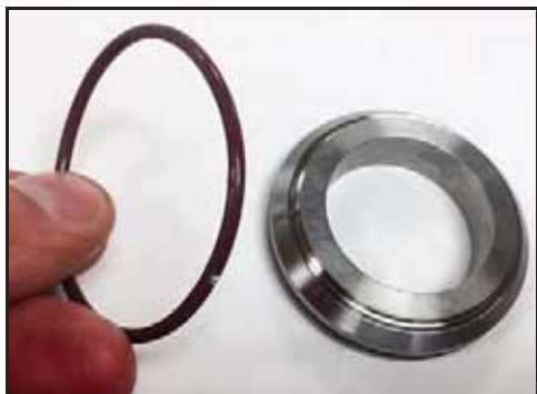
Bild 45 – Ta bort O-ringen som sitter mellan boxen och skruvrotorn
