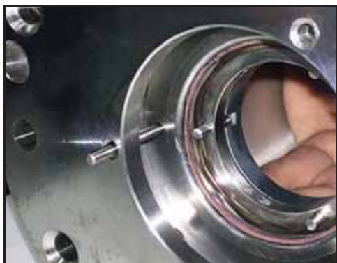
Bild 78 – Använd drivstift för att rikta in hål
