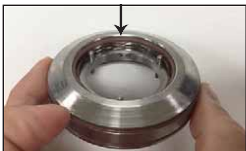
Bild 70 – Monterad O-ring mellan tätningshållare och tätning
