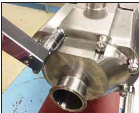
Bild 132 – Åtdragning av lockmuttrar
