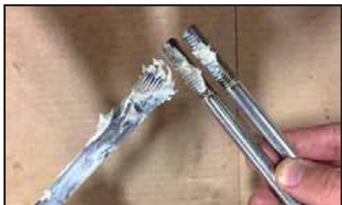
Bild 89 – Applicering av antikärvmedel på gängorna
