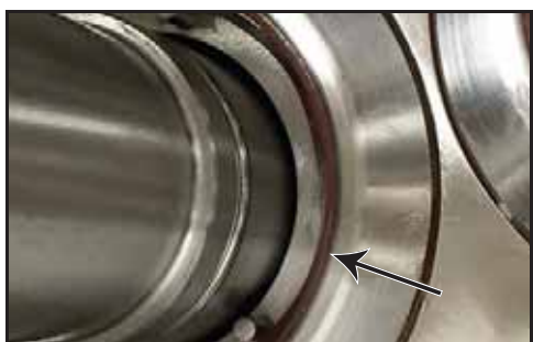
Bild 93 – Montera O-ring mellan tätningsinsatsen och tätning
