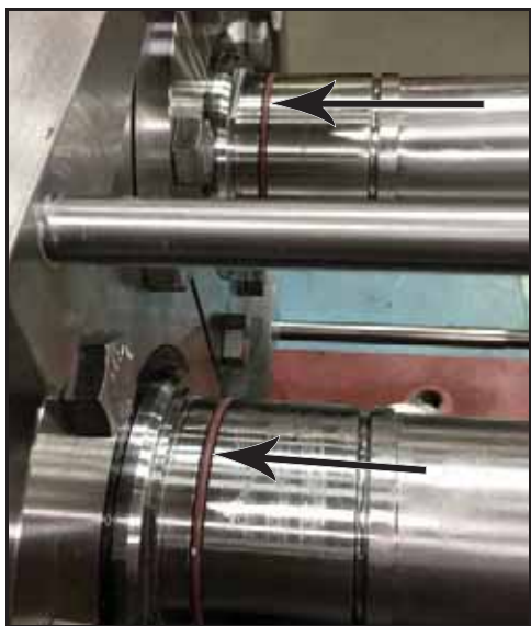
Bild 84 – Montera O-ringarna på axlarna
