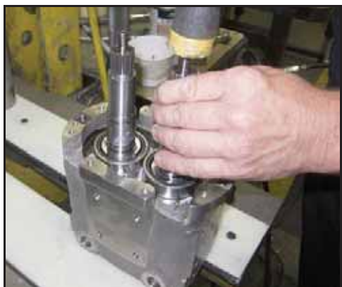
Bild 191 – Knacka på axlarna för att centrera dem i hålen
