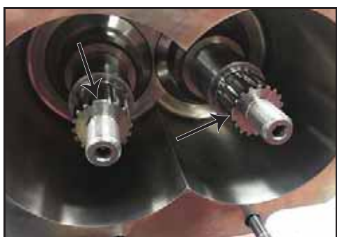
Bild 108 – Rikta in skruv och axelspline
