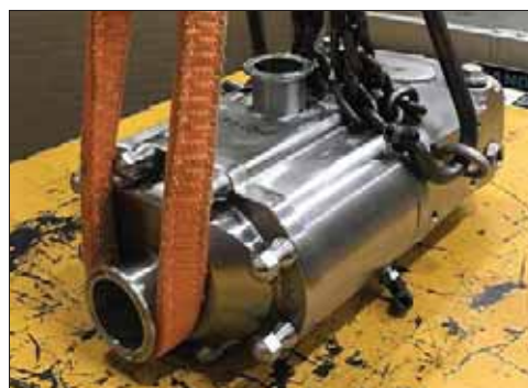
Bild 2 – Detalj från placering av lyftanordningar – 015, 030-UTS
