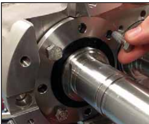
Bild 143 – Lossa och ta bort lagerhållarens fästsruvar
