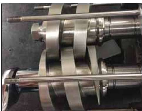
Bild 220 – Montering av fästmuttrar
