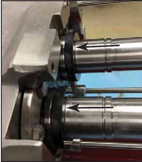
Bild 53 – Ta bort tätningarnas säte
