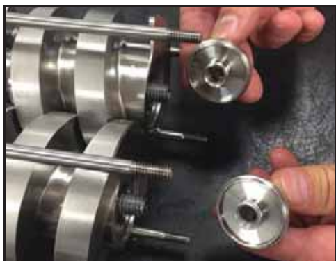
Bild 217 – Montering av fästmuttrar
