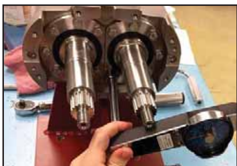
Bild 201 – Momentdra skruvar på lagerhållaren
