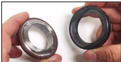
Bild 101 – Rikta in packboxen och tätningens säte
