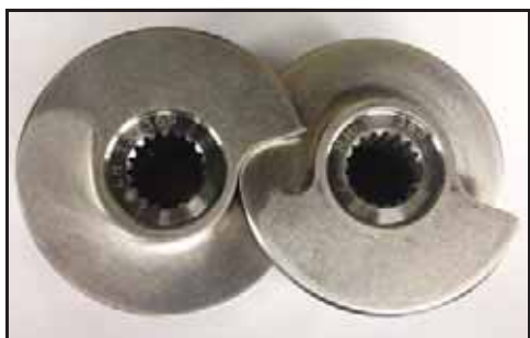
Bild 107 – Placera skruvarna på detta sätt: LH-RH
