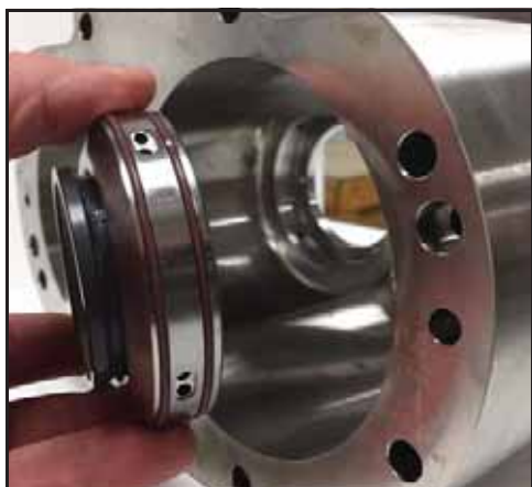
Bild 57 – Ta bort tätningshållaren från pumphuset
