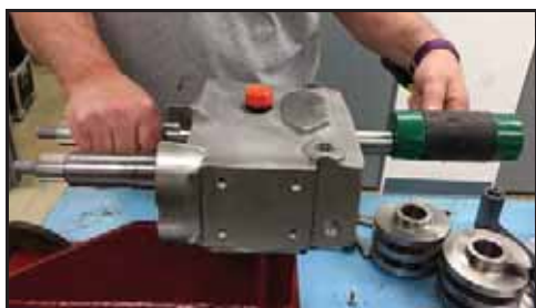
Bild 145 – Knacka loss drivaxeln ur växellådan
