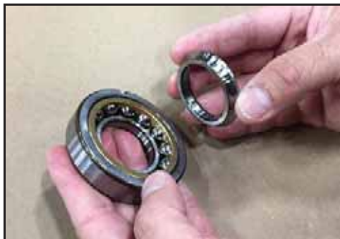
Bild 160 – Ta bort den nedersta ringen
