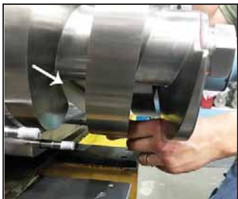
Bild 126 – Blockerad skruv (höger)
