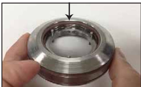
Bild 59 – Monterad O-ring mellan tätningshållare och tätning
