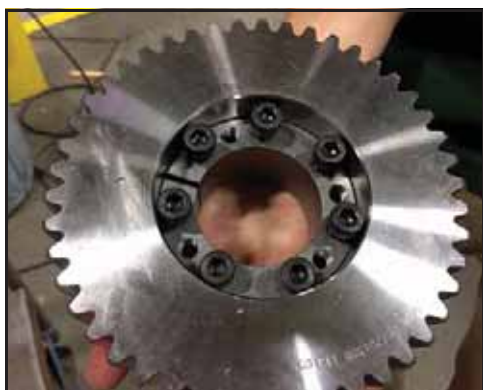
Bild 212 – Placera låsanordningen i kugghjulet
