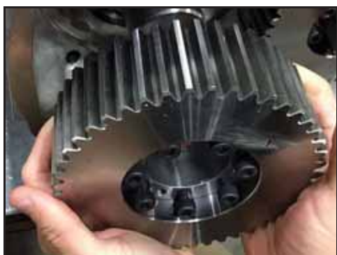
Bild 139 – Ta av kugghjul
