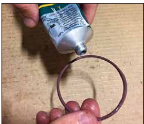
Bild 83 – Smörjning av O-ringar
