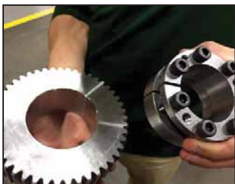
Bild 211 – Montera låsanordning i kugghjulet
