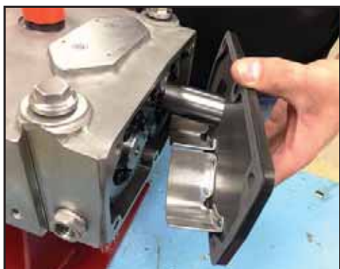
Bild 235 – Montera växellådans hölje
