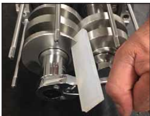
Bild 219 – Montering av fästmuttrar
