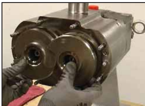
Bild 41 – Ta bort skruvar
