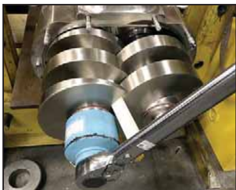
Bild 125 – Momentdragning av vänstra fästmuttern
