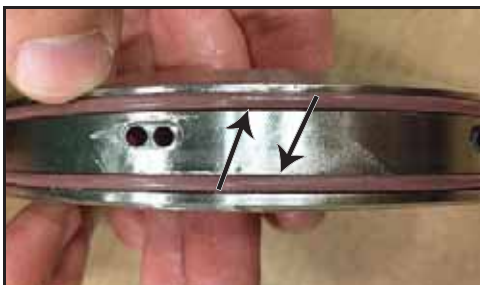
Bild 62 – O-ringar mellan tätningshållare och pumphus
