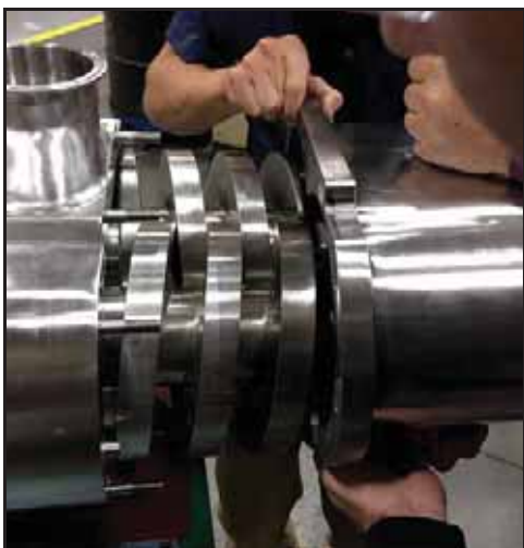
Bild 129 – 220-UTS Montering av pumphölje
