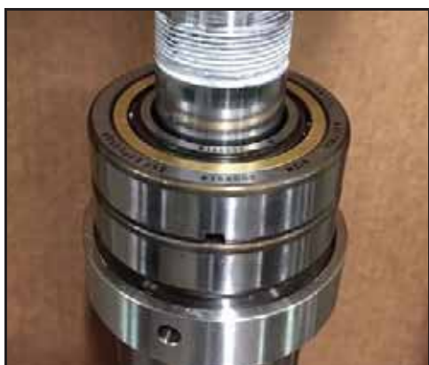
Bild 173 – Det andra lagret är monterat
