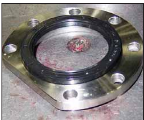
Bild 193 – Centrera lagerhållarens tätning
