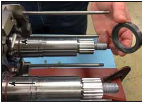
Bild 54 – Ta bort O-ringar från axlarna
