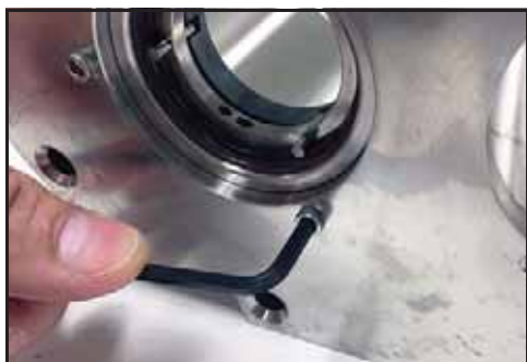
Bild 56 – Ta bort lockskruvar
