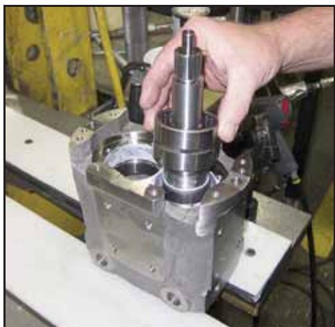
Bild 188 – Placera den yttre ringen på axeln
