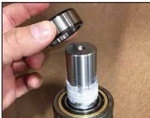
Bild 175 – Sätt fast ringen på axeln
