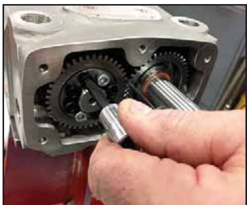
Bild 226 – Dra åt låsbultar för hand
