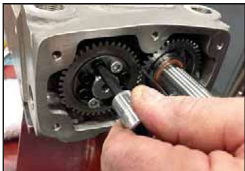
Bild 137 – Lossa bultarna i låsanordningen
