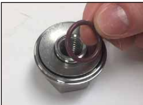
Bild 114 – Montera O-ring som håller brickan på plats
