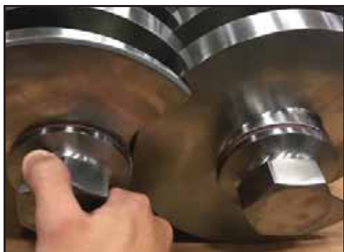
Bild 124 – Montering av fästmuttrar
