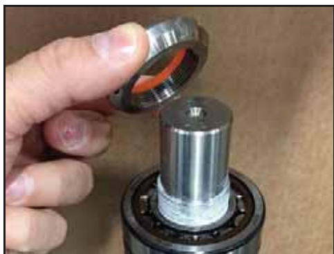
Bild 178 – Placera låsmuttern på axeln
