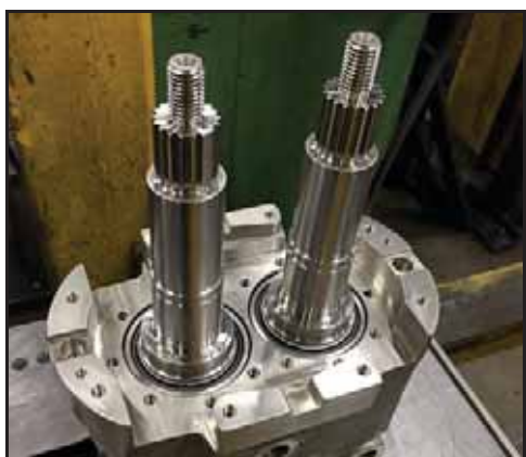
Bild 192 – Installerade axlar i växellåda
