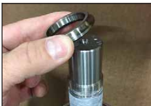
Bild 162 – Sätt fast ringen på axeln
