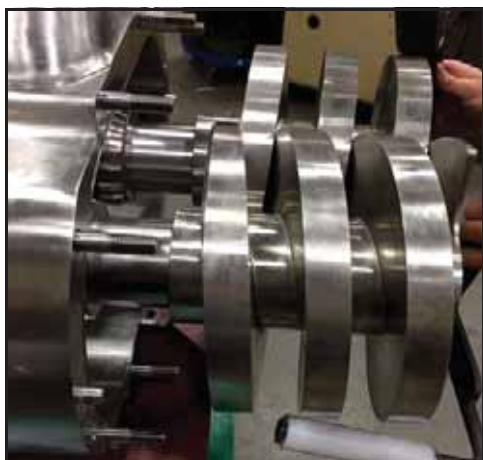
Bild 110 – Skjut fast skruvarna på axlarna
