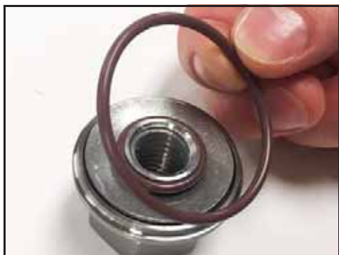
Bild 116 – Montering av O-ringen på muttern
