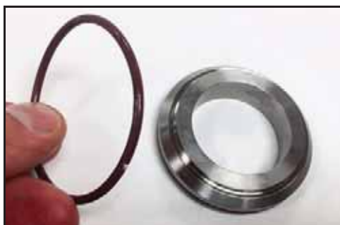
Bild 99 – Montera O-ring mellan packbox och skruv
