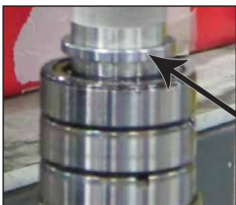
Bild 180 – Tryck fast lagrets mellanlägg på drivaxeln
