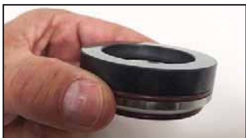
Bild 102 – Sätet monterat på boxen
