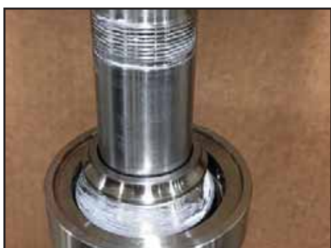
Bild 164 – Ringen fasttryckt på axeln
