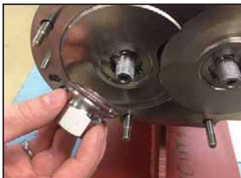
Bild 119 – Montering av fästmuttrar
