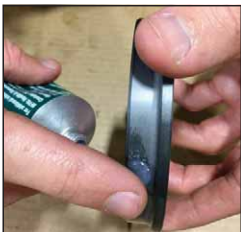
Bild 81 – Smörj tätningens utsida
