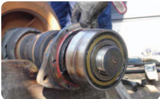
Смяна на лагери и работно колело на центробежна помпа
