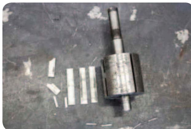
Смяна на пластините на ламелна помпа
