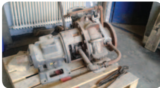
Повредена центробежна помпа за горещо масло Проблем: наличие на теч на работния флуид
