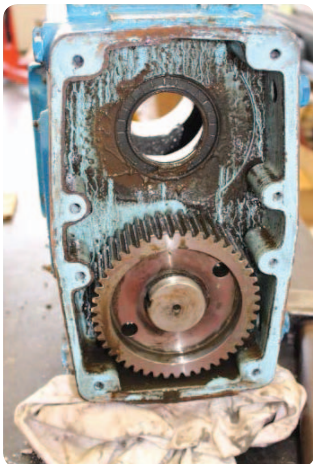
Ремонт на разпределителна кутия на лобна помпа Waukesha
