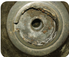
3. Отстраняване на дефектиралите механични уплътнения, O-пръстени и семеринги. Подготовка на повърхнините за монтаж на новите части.
