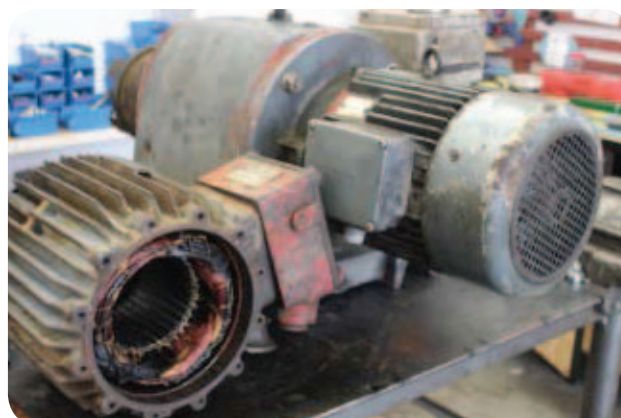
Смяна на дефектирал електрически мотор
