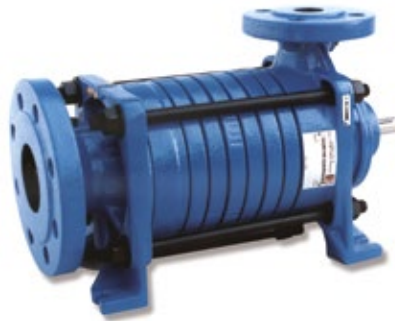
TBA – KONSTRUKCE SAMONASÁVACÍHO VYSOKOTLAKÉHO ČERPADLA S VELMI NÍZKÝM NPSHR SCHOPNÁ ČERPAT KAPALINY NA MEZI VARU S MINIMALIZACÍ RIZIKA KAVITACE; KOMPAKTNÍ LOŽISKOVÝ ŠTÍT, KRÁTKÁ HŘÍDEL A TÍM KOMPAKTNÍ ROZMĚRY VYLUČUJÍ VIBRACE, COŽ PRODLUŽUJE ŽIVOTNOST LOŽISEK A UCPÁVKY.
