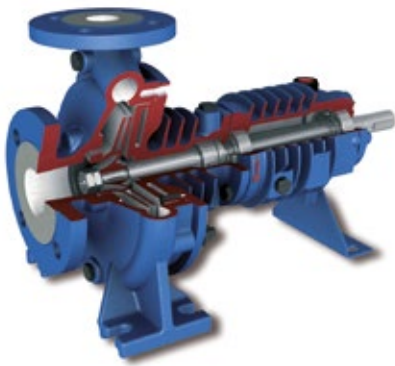
TCD - KONSTRUKCE PRO TEPLSMĚNNÉ OLEJE DO 320°C S JEDNODUCHÝMI MECHANICKÝMI UCPÁVKAMI BEZ NUTNOSTI CHLAZENÍ ODVOZENÉ OD DIN 24258 NORMY CHEMICKÝCH ČERPADEL; LOŽISKA JSOU MAZÁNA LOŽISKOVÝM OLEJEM A NIKOLI ČERPANOU KAPALINOU JAKO U KONKURENČNÍCH VÝROBKŮ.
