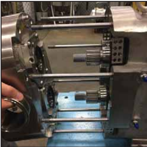
Abbildung 127 - Montage des Pumpengehäuses
