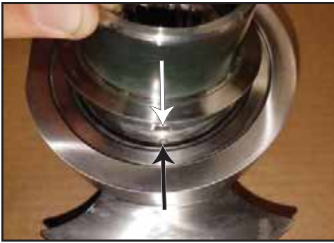
Abbildung 171 - Aussparung und Zapfen fluchten
