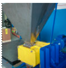
Kompakter Aufbau mit Hydraulikmotor
