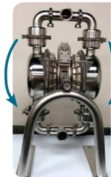
Drehbarer Korpus zur CIP-Reinigung
