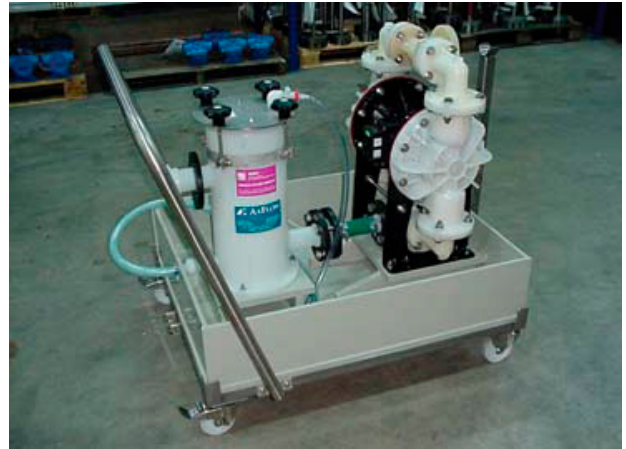
Beispiel eines mobilen Filtrationswagens mit Standardpumpe in Kunststoff-Ausführung.
