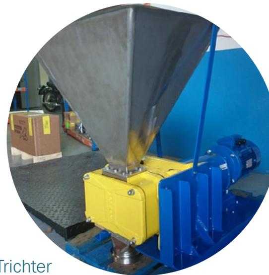
Vertikale Montage mit Trichter
