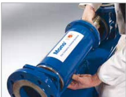
4. Rotor und Stator aus der Pumpe herausheben
