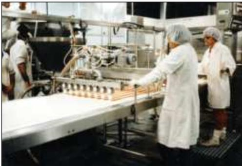
Ein führender Maschinenkonstrukteur und -bauer, der sich auf Maschinen für die Pastetenherstellung spezialisiert, verwendet in seinen Maschinen W032 Edelstahlpumpen. Diese Pumpen führen die vorbereiteten Fleischrollen mit einer Förderleistung von 5-10 m<sup>3</sup>/h in einheitlicher Länge dem Teig zu. Prozesspumpen der W-Reihe verfügen über ein Schneckenzuführsystem, das dafür sorgt, dass das Fleisch kontinuierlich vom Trichtereinlass zum Pumpenelement befördert wird.
