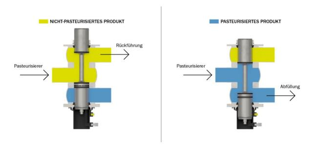
Dieses Setup macht ein Einsitzventil und ein weiteres vermischungssicheres Ventil überflüssig, während mittlere und obere Ventilkammer in der Anlage sicher gereinigt werden können. Bei dem neuen vermischungssicheren, hygienischen APV D4 Umschaltventil kommen viele Bauteile und Konstruktionsmerkmale der anderen D4-Baureihen zum Einsatz, so dass Serviceaufwand und Ersatzteilhaltung für den Anwender reduziert werden. Die APV D4 Ventilreihe ist jetzt bei AxFlow erhältlich.
