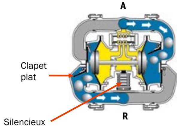
Pompes Sandpiper métalliques à clapets plats, recommandées pour le transfert de liquides peu à très visqueux, contenant des particules.
