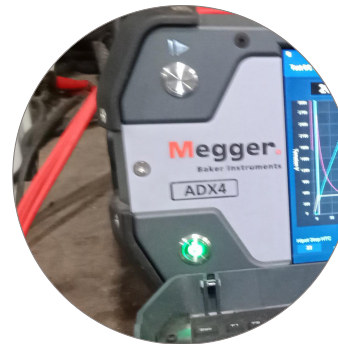
Tests par onde de choc MEGGER
