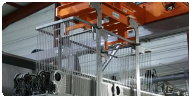
LIGNE DE DÉGRAISSAGE / DÉTARTRAGE ROBOTISÉE
