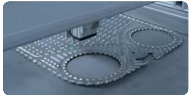
ENCOLLAGE DES JOINTS AU ROBOT
