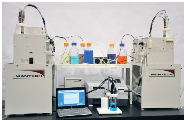
ESEMPIO DI STAZIONE DI LAVORO, CONSENTE DI ANALIZZARE FINO A 13 PARAMETRI IN MODO AUTOMATICO E CON SINGOLA ANALISI.
