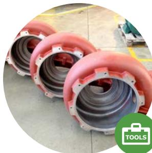
Rivestimento interno ed esterno del corpo pompa con resine speciali per migliorarne la resistenza meccanica o prevenirne la corrosione.
