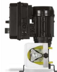
Pompe peristaltiche ideali per basse pressioni e per applicazioni di laboratorio, dosaggio accurato di piccole quantità fino a 90 l/h ad una pressione di 2 bar. La configurazione a tre rulli riduce le vibrazioni e la sostituzione del tubo è più veloce e semplice.
