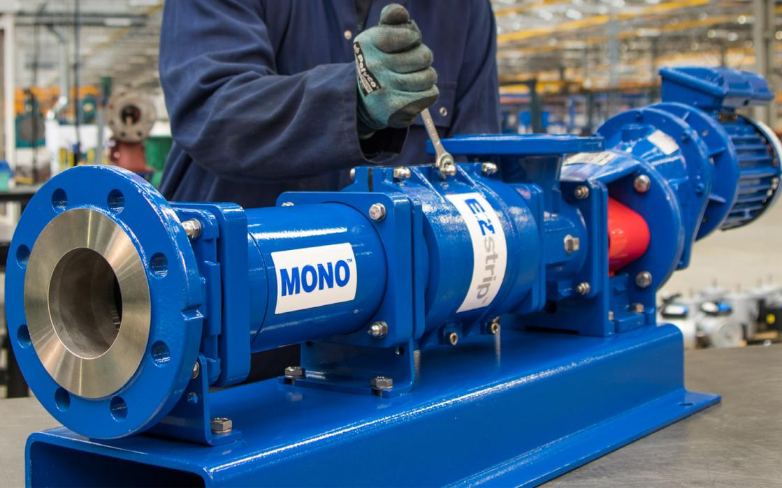
L'innovativo sistema di accoppiamento tra pompa e azionamento garantisce facilità e rapidità di manutenzione sul posto.
