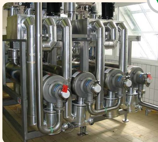
Waukesha Cherry-Burrell geschraapte warmtewisselaars voor het terugkoelen van warme pindakaas.
