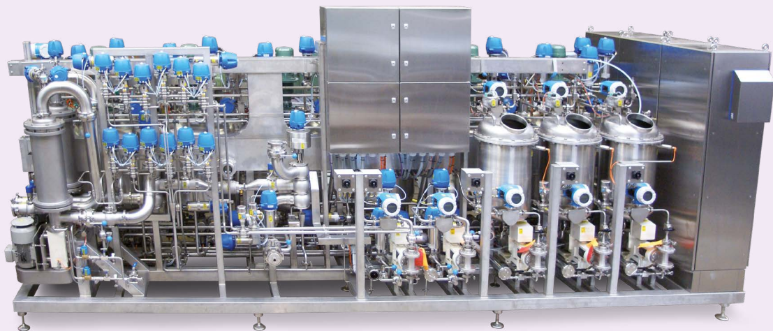
Een totaaloplossing voor het mengen en doseren van kleur- en smaakstoffen in de productie van tandpasta (personal care).
