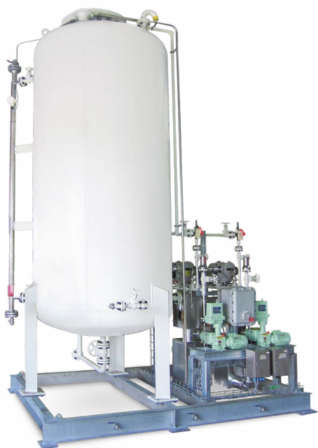
Opslagtank met voorverwarmde zuigleiding in verband met hoge viscositeit bij koud product (corrosion inhibitor).
