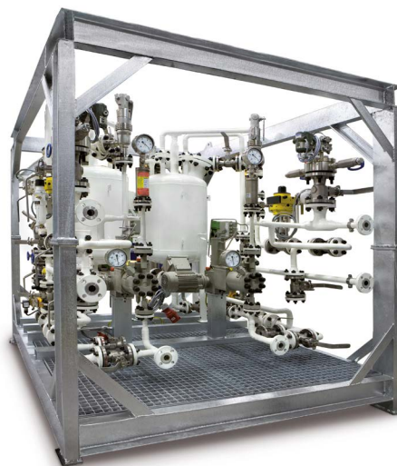
Een gegalvaniseerd box frame voor twee opslagtanks en twee doseerpompen voor het doseren van chemische producten.
