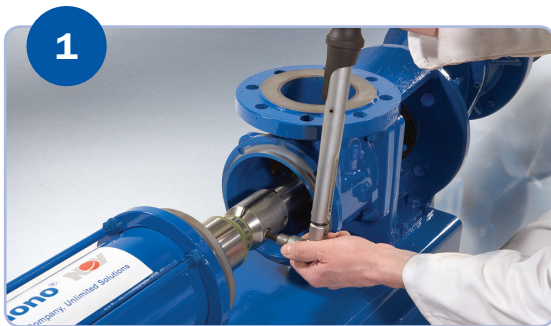
Aufschrauben der Gelenk-Manschette
