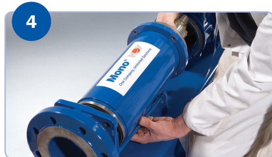
Rotor und Stator aus Pumpe entfernen
