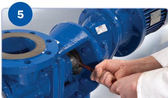
Wellenschutz zurückziehen und Mitnehmerstift aus Welle entfernen
