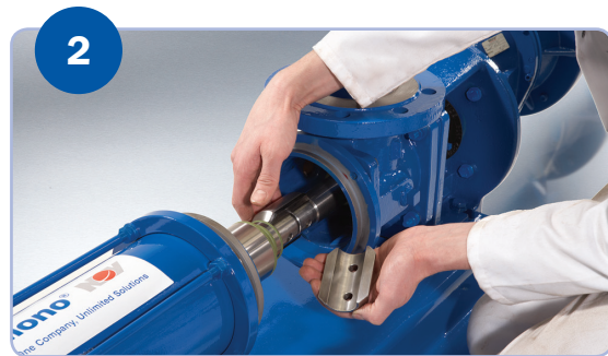
Entfernen der geteilten Gelenk-Manschette
