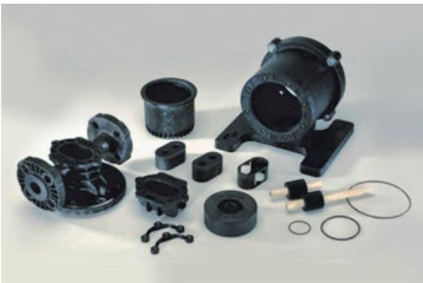
Die Eclipse Zahnradpumpen wurden von Beginn an so konzipiert, dass ein Austausch von Verschleißteilen möglichst schnell und einfach durchgeführt werden kann. Alle relevanten Bauteile können von vorne entnommen und wieder eingebaut werden. Das gilt auch für den Gehäuse-Inliner, der ebenso wie die Zahnräder, Wellen und Lagerbuchsen, Bestandteil des sogenannten KOPkits® ist.
