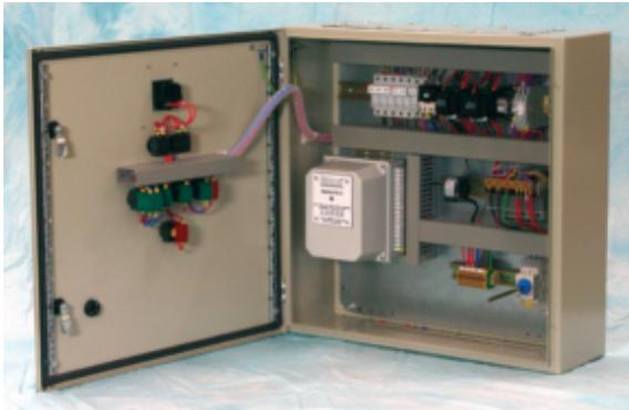
Die Muncher PLC-Einheit kann zwischen einer Blockage und zwischen geringer und schwerer Überlast unterscheiden. Tritt eine Überlast oder Blockage auf, beginnt der Muncher sofort zu reversieren. Um ein unnötiges Reversieren zu vermeiden, wird die Arbeitsweise des Munchers von der Elektronik kontinuierlich überwacht. Nur bei einem kritischen Kraft-Zeit-Verhältnis oder einer echten Überlast wird ein Reversiervorgang oder das Abschalten der Maschine eingeleitet.
