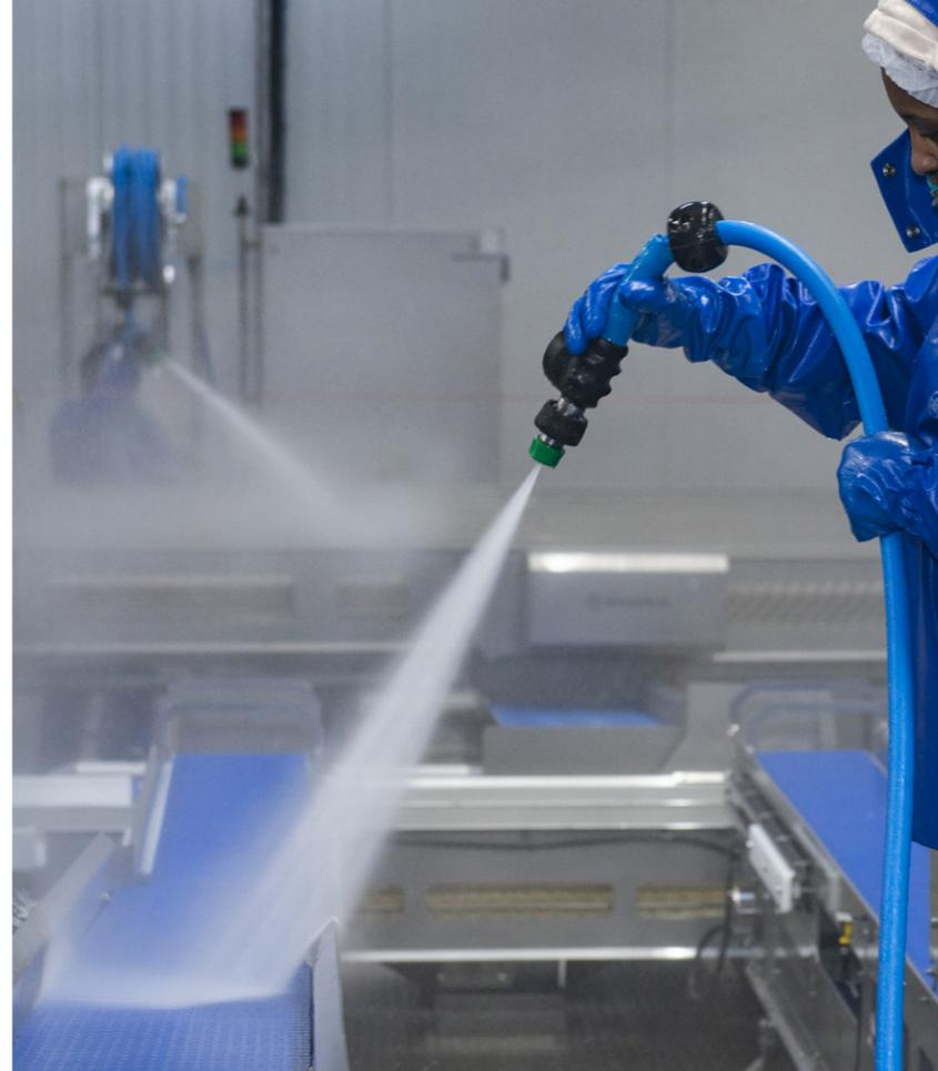
Niederdruck-Reinigung mit druckerhöhtem Wasser schützt die Prozessumgebung vor Mikroorganismen und minimiert so die Rekontamination von Oberflächen
