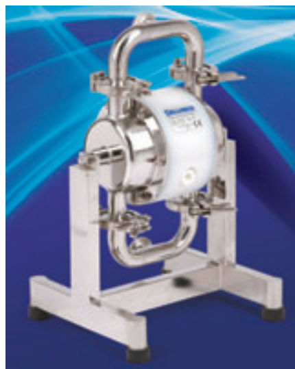
POMPĂ CU EXECUȚIE IGIENICĂ, ÎNVELIȘ ELECTROPOLIZAT SS 316L, DEZASAMBLARE RAPIDĂ PENTRU UȘURAREA CURĂȚĂRII
