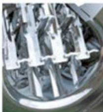
Les écoulements d'additifs à faible viscosité, guidés le long de la rigole de chaque lamelle, sont croisés de façon abrupte par des courants transversaux à écoulement rapide qui s'écoulent dans la direction opposée.
