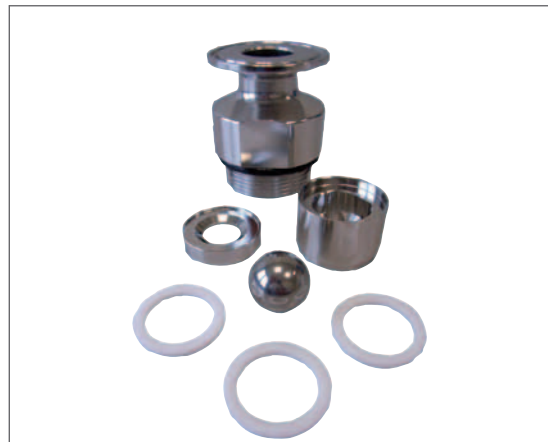
Clamp-Anschluss und Kugelventil in SS316L mit Ra 0,8µm, PTFE-Dichtungen (FDA)
