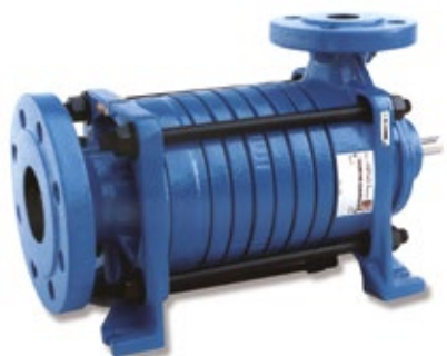
TBA – KONŠTRUKCIA SAMONASÁVACIEHO VYSOKOTLAKOVÉHO ČERPADLA S VEĽMI NÍZKYM NPSHR SCHOPNÉ ČERPAŤ KVAPALINY NA MEDZI VARU S MINIMALIZÁCIU RIZIKA KAVITÁCIE; KOMPAKTNÝ LOŽISKOVÝ ŠTÍT, KRÁTKY HRIADEĽ A TÝM KOMPAKTNÉ ROZMERY VYLUČUJÚ VIBRÁCIE, ČO PREDLŽUJE ŽIVOTNOSŤ LOŽÍSK A UPCHÁVKY
