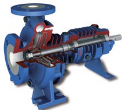
TCD – KONŠTRUKCIA PRE TEPLÝMENNÉ OLEJE DO 320 °C S JEDNODUCHÝMI MECHANICKÝMI UPCHÁVKAMI BEZ NUTNOSTI CHLADENIA ODVOĎENÁ OD NORMY DIN 24258 CHEMICKÝCH ČERPADIEL; LOŽISKÁ SÚ MAZANÉ LOŽISKOVÝM OLEJOM A NIE ČERPANOU KVAPALINOU AKO PRI KONKURENČNÝCH VÝROBKOCH
