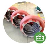
Rivestimento interno ed esterno del corpo pompa con resine speciali per migliorarne la resistenza meccanica o alla corrosione.
